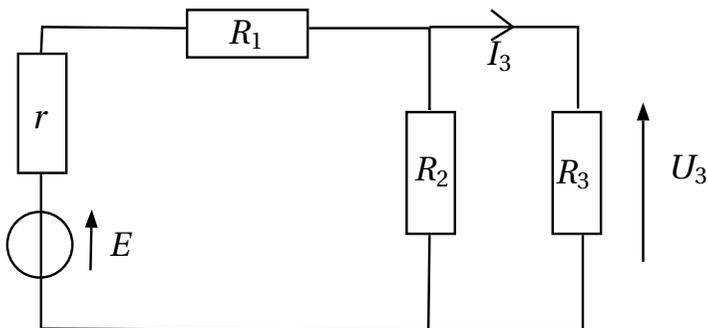
a. La tension  $U_3$  peut être obtenue en appliquant la formule du diviseur de tension :
