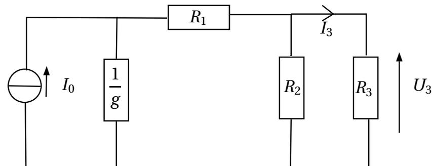
Le problème se traite en utilisant l'équivalent THÉVENIN de la source de courant avec  $E = \frac{I_0}{g}$  et  $r = \frac{1}{g}$ . On a alors :
