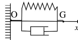
5. Le dispositif de freinage absorbe une fraction  $E_a = 778$  J de l'énergie cinétique initiale. Calculer la nouvelle valeur  $k_2$  de la constante de raideur du ressort avec les données numériques précédentes. Déterminer la pulsation propre de l'oscillateur.
