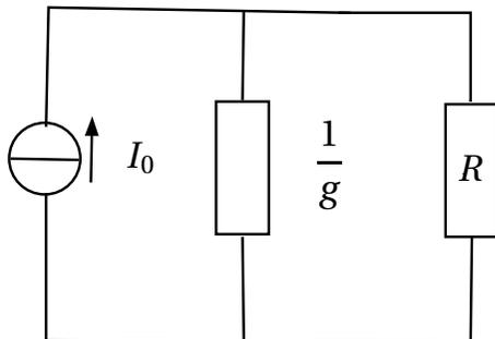
Le circuit est constitué de 3 branches en parallèle : le générateur de courant parfait, sa résistance interne  $r = 1/g$ , et la résistance  $R = 1/G$ . Aux bornes de l'ensemble, la tension vaut :  $U = \frac{I_0}{G+g}$ .
